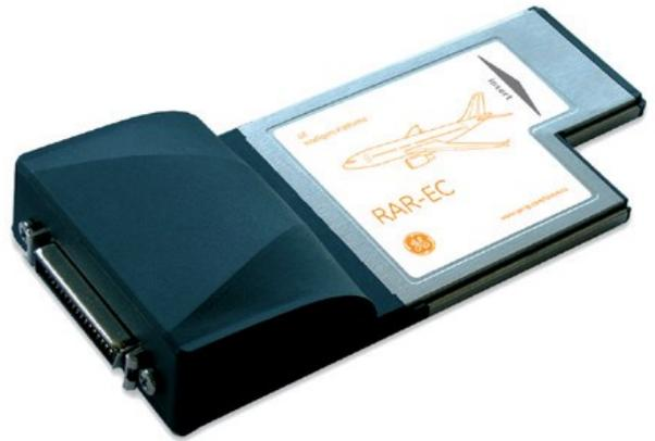
Abaco SystemsのRAR-ECは、高密度、最大計11のTx/Rx完全独立ARINC 429/575チャンネル、最大4つの双方向アビオニクス・レベルI/Oディスクリットを提供するインテリジェントなExpressCardです。機能は、プログラム可能なデータ速度とパリティ、エラー検知、マルチ・バッファ・モード、タイムタグおよび、自動送信スルー速度調整を含みます。
