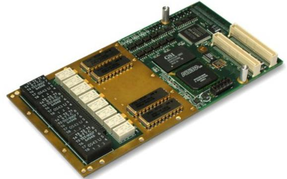
Abaco SystemsのQPM-1553はPMC (PCI メザニンカード) モジュールで、MIL-STD-1553A/B Notice II最新世代の性能および、柔軟性を提供します。コマーシャル、耐環境、コンダクション・クーリング、1、2または、4二重冗長チャンネルが利用できるQPM-1553は、アプリケーションの開発時間を短縮する先進的なAPI (Application Programming Interface) ソフトウェアを含みます。
