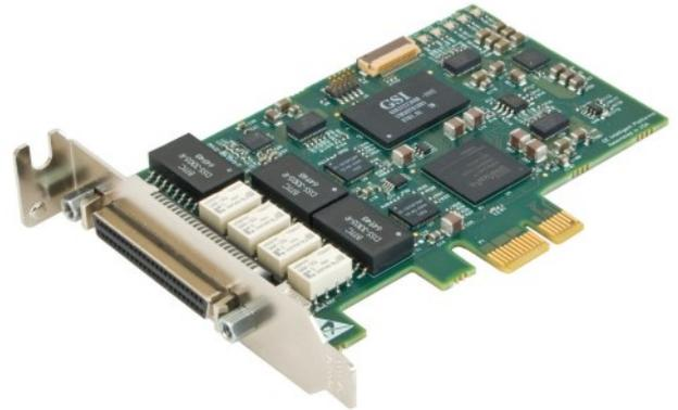
Abaco SystemsのR15-LPCIEは、ロープロファイルPCI Expressモジュールで、MIL-STD-1553A/B Notice II最新世代の性能および、柔軟性を提供します。-40~70°C、1または、2二重冗長チャンネル、R15-LPCIEはアプリケーションの開発時間を短縮する先進的なAPIを含みます。
